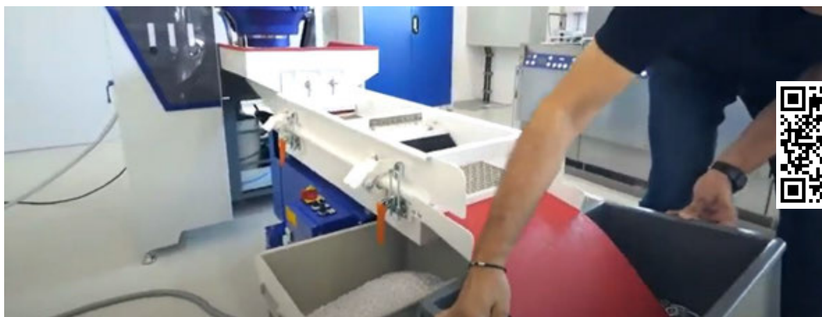
Специальная разработка ОТЕС – система вибрационной сепарации UNISEPA (полуавтомат, передвижная, на колесиках) совместима со всеми машинами серии CF
